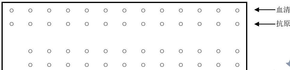
附图 小板（100mm×45mm）打孔模型图案
